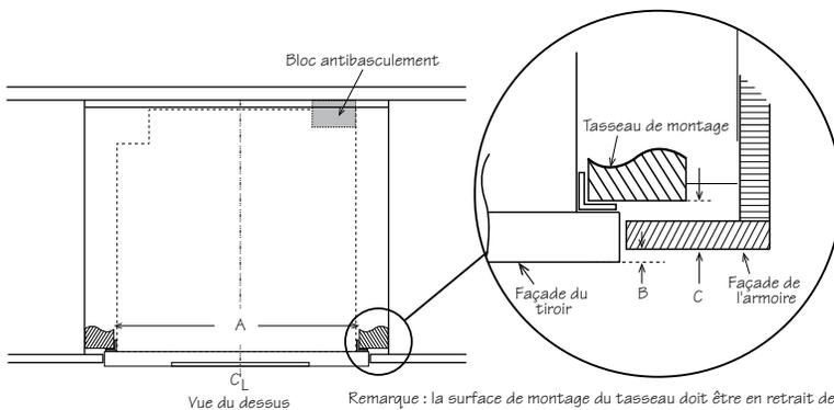
Remarque : la surface de montage du tasseau doit être en retrait de 1 1/16 po (26,97 mm) de la façade de l'armoire [poussant la façade du tiroir vers l'extérieur de 1/4 po (6,35 mm)].
