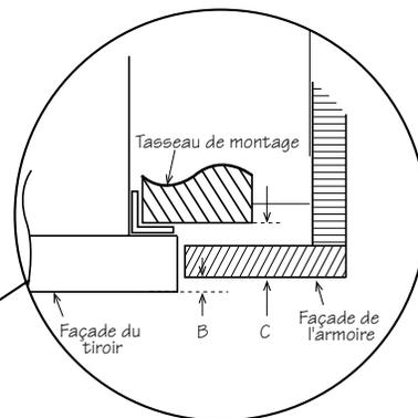
Remarque : la surface de montage du tasseau doit être en retrait de 1 1/16 po (26,97 mm) de la façade de l'armoire [poussant la façade du tiroir vers l'extérieur de 1/4 po (6,35 mm)].
