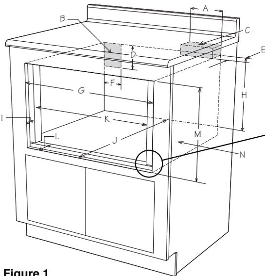
Remarque : la façade de la tablette doit être en retrait de 1 3/4 po (44,5 mm) de la façade de l'armoire.
